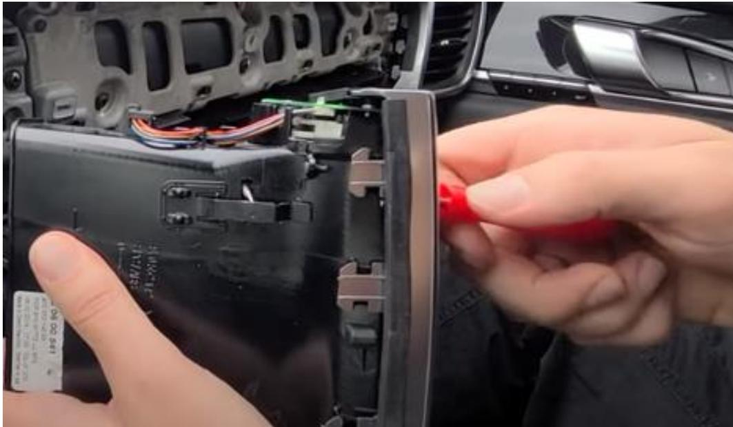
Wenn die Gitter zu eng sind, entfernen Sie die Frontplatten links und rechts von den Gittern (sie werden nur eingeklipst).
