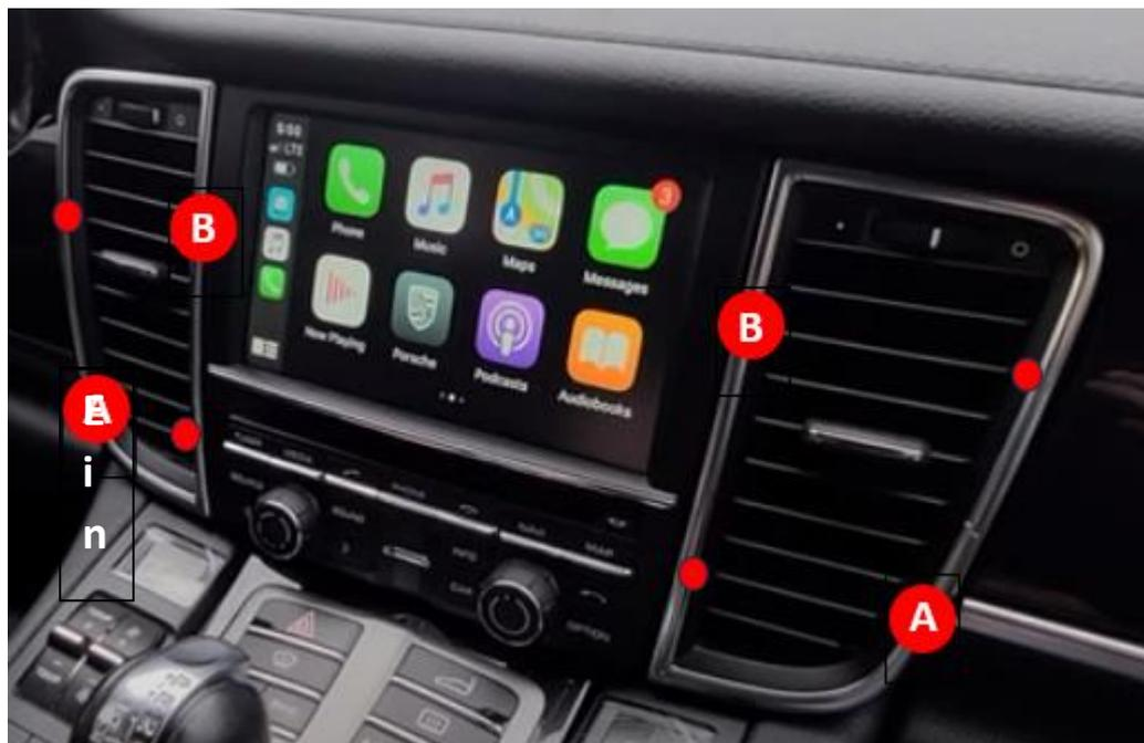
Führen Sie die ersten Teile des Entriegelungswerkzeugs von unten in den dritten Luftschlitz (Clip A) ein. Stecken Sie den Haken durch die Öffnung (in ca. 5 cm Tiefe) und auf den Metallclip. Setzen Sie das zweite Entriegelungswerkzeug von oben unter den Luftschlitz (Clip B) ein. Stecken Sie den Haken durch die Öffnung (in ca. 5 cm Tiefe) und auf den Metallclip.
